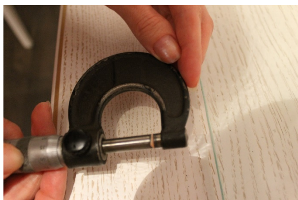
Рисунок 4 – Определение толщины скорлупы яиц
